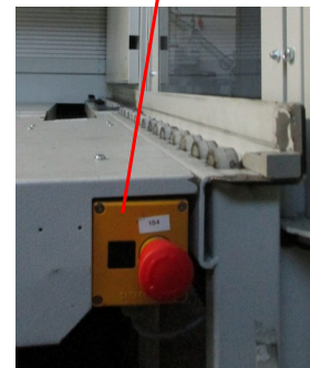
Rys. 30: Automatyczne wysuwanie z wyłącznikiem głównym po lewej stronie regału i przycisk zatrzymania awaryjnego po prawej stronie regału.
